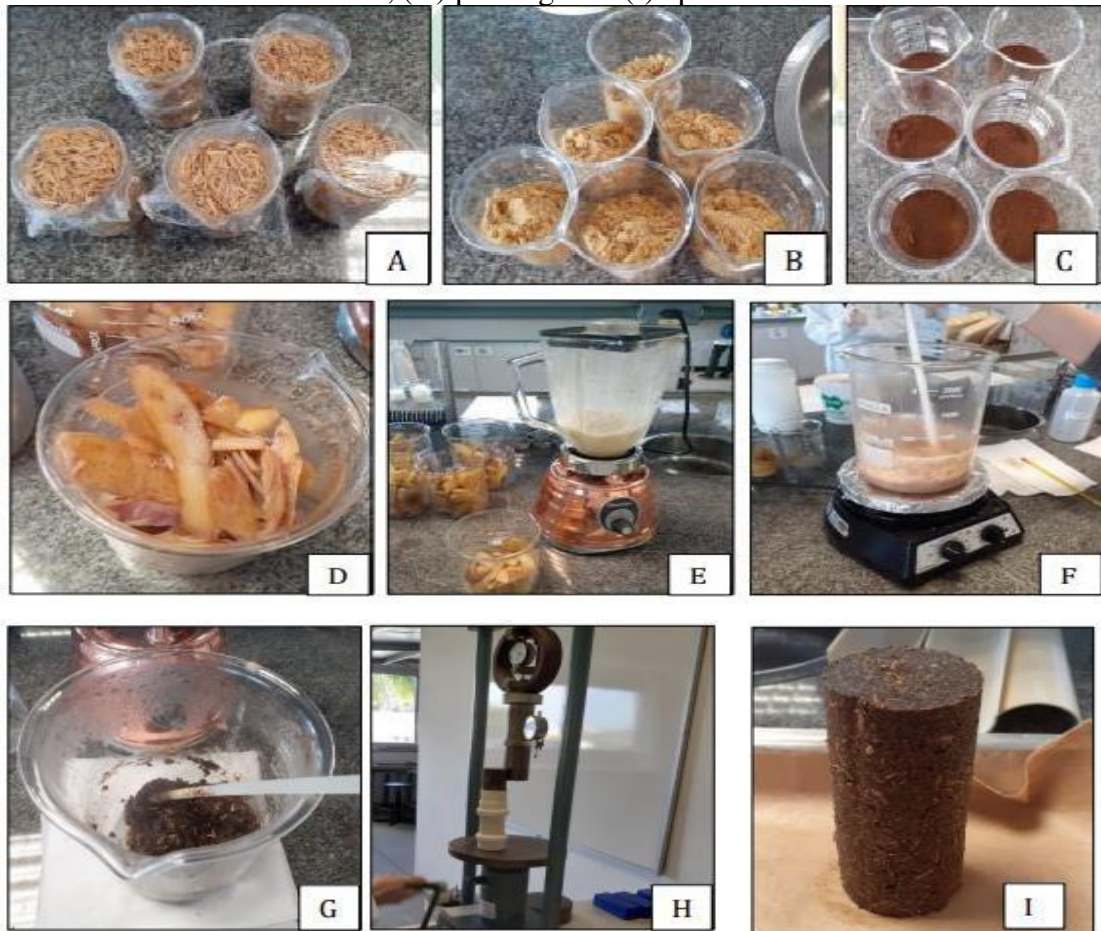
Figura 1: Preparação dos briquetes, sendo (A) casca de arroz, (B) casca de laranja, (C) borra de café, (D) casca de batata, (E) moagem da casca de batata, (F) aquecimento e mistura, (G) mistura final, (H) prensagem e (I) após o desmolde.
