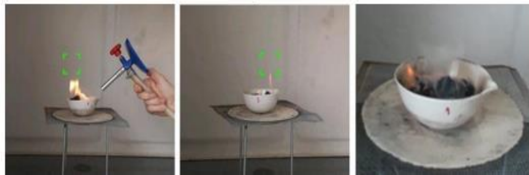
Figura 3: Queima de biocombustíveis sólidos, Amostra 3 confeccionados com biomassa de 100 g de casca de batata inglesa e 70 g borra de café.
